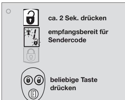
Im Auslieferungszustand ist keine Fernbedienung angelernt. Die erste Fernbedienung, die angelernt wird, ist automatisch die Master-Fernbedienung. Für diese ist auch der Speicherplatz „1“ reserviert.
